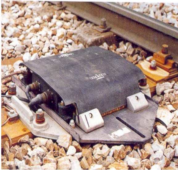
شکل ۷-۳-۳- سنسور فرستنده اطلاعات AVI نصب شده در وسط خط [۴۱]
