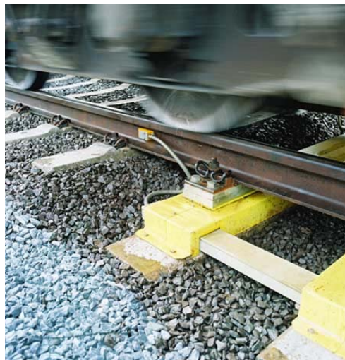
شکل ۳-۶- نمونه‌ای از سیستم تشخیص بریدگی چرخ [۲۶]
