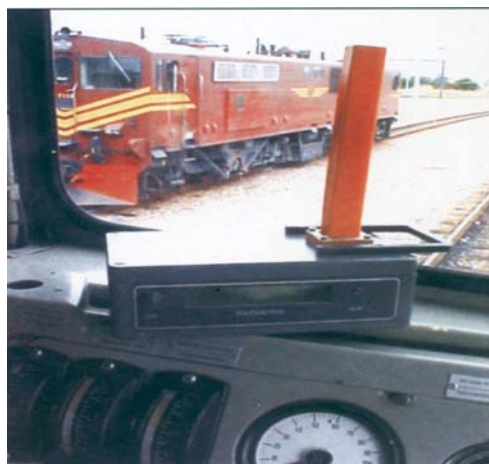
گیرنده داخل کابین قطار جهت آگاهی دادن انفصال به راننده
