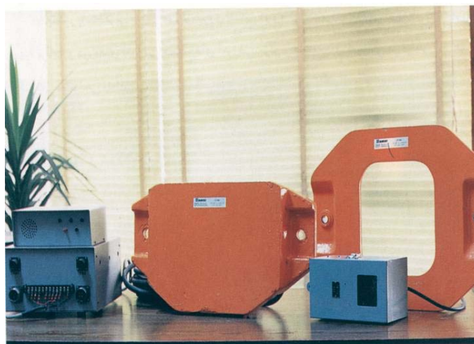
شکل ۷-۱-۱۴- نمونه‌ای از تجهیزات تشخیص عبور کامل قطار از محدوده مشخص
