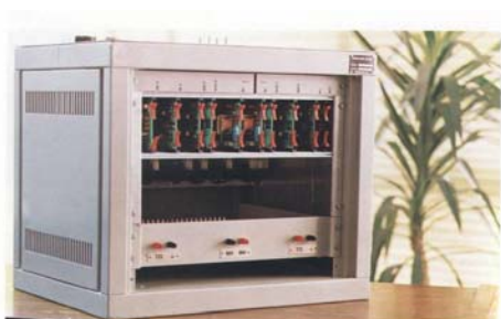
شکل ۷-۱-۱۱- سخت‌افزار رابط سیستم اینترنت‌لاکینگ با اپراتور [۲۸]
