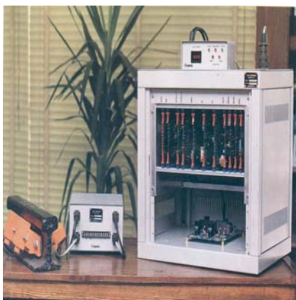
شکل ۷-۱-۱۳- نمونه‌ای از سنسورها و راک سیستم محور شمار [۲۸]
