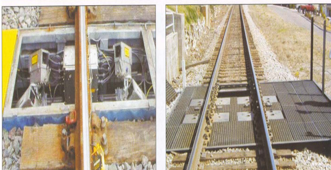
شکل ۷-۳-۶- سیستم تشخیص بریدگی و تیزی چرخ [۵۵]
